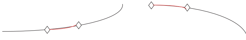
图9 不封闭轮廓线任意段拾取结果
